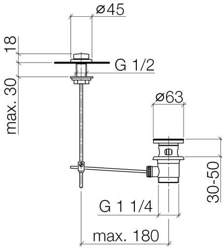
Garniture d'écoulement avec bouton à tirer pour montage sur gorge 1 1/4" -
